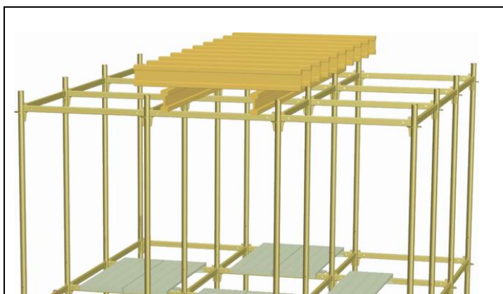
Рис. 3.1. Продольный и поперечный набор опалубки ж.б. балки.
